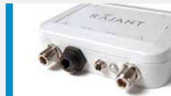
El BreadCrumb ES1 es un dispositivo IP67 con múltiples opciones de montaje, lo que lo hace ideal para aplicaciones de IIoT como las que se utilizan para control de la bomba de varillas (RPC) y para su despliegue en vehículos de carga liviana.
