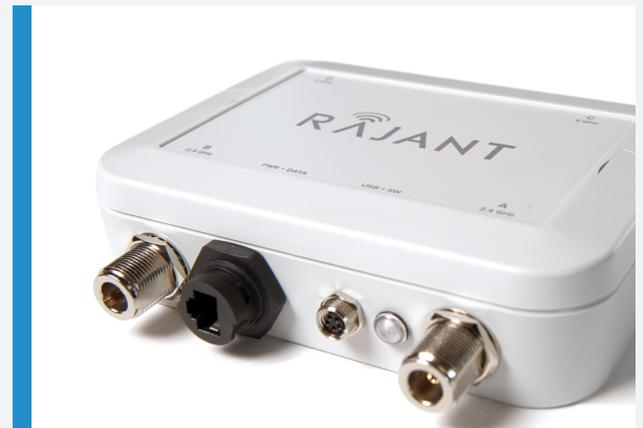
*BreadCrumb ES1 — это устройство с классом защиты IP67 и множеством вариантов установки. Оно идеально подходит для IIoT-приложений, например для интеллектуальных сетевых устройств, а также для установки на автомобилях малой грузоподъемности.*
