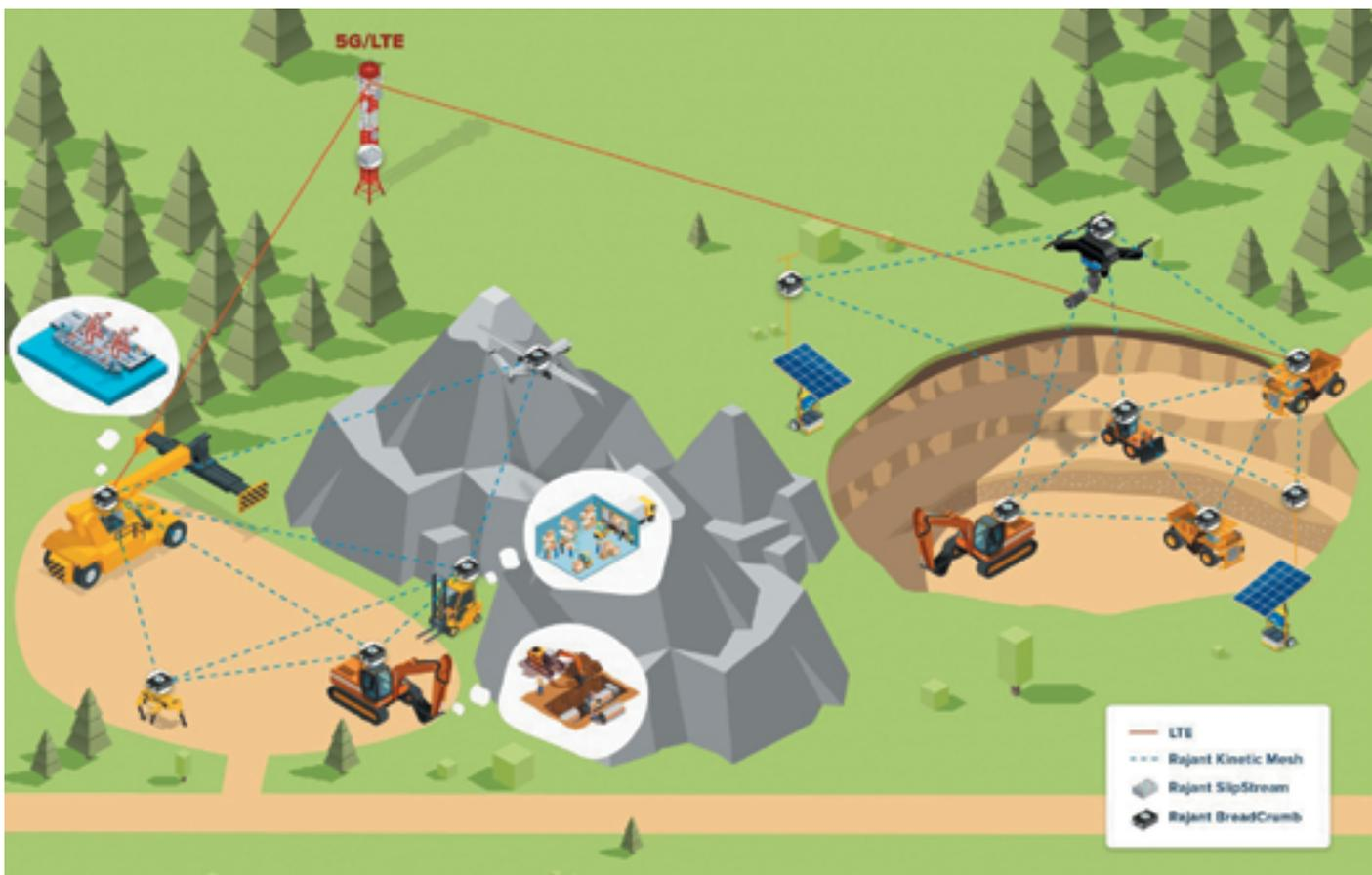
может работать одновременно и в Kinetic Mesh, и в сотовых сетях, выбирая лучший маршрут в режиме реального времени, чтобы объединить технологии в единую сеть и обеспечить высокую надёжность.
